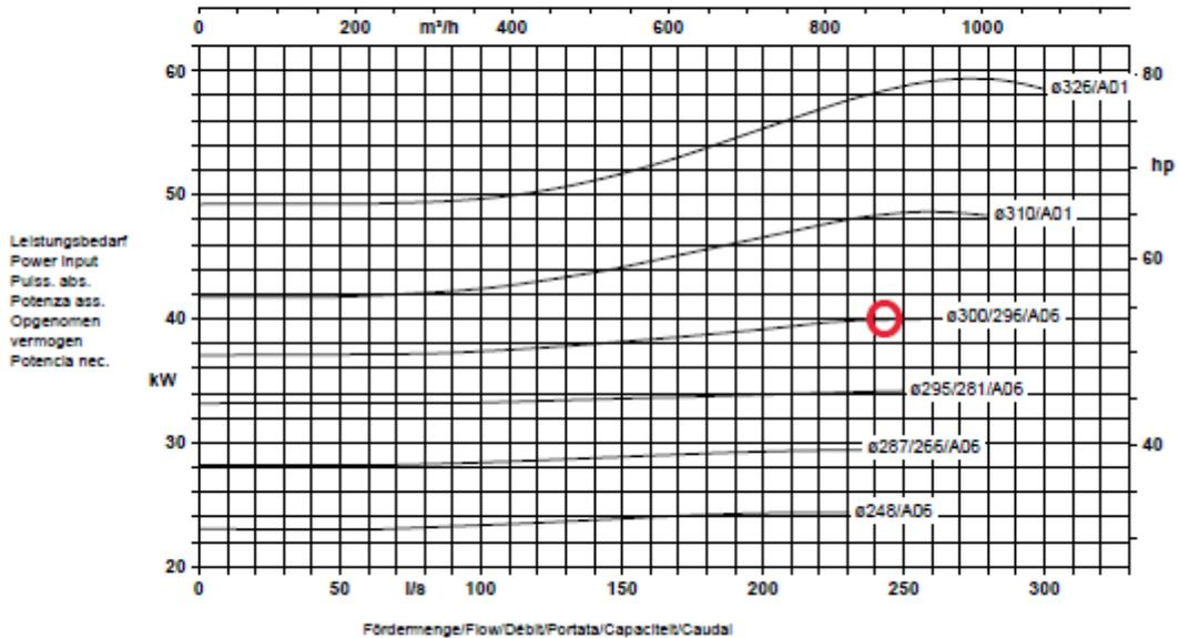
Laufraustrittsbreite/Impeller outlet width/Largeur à la sortie de la roue 92 mm
