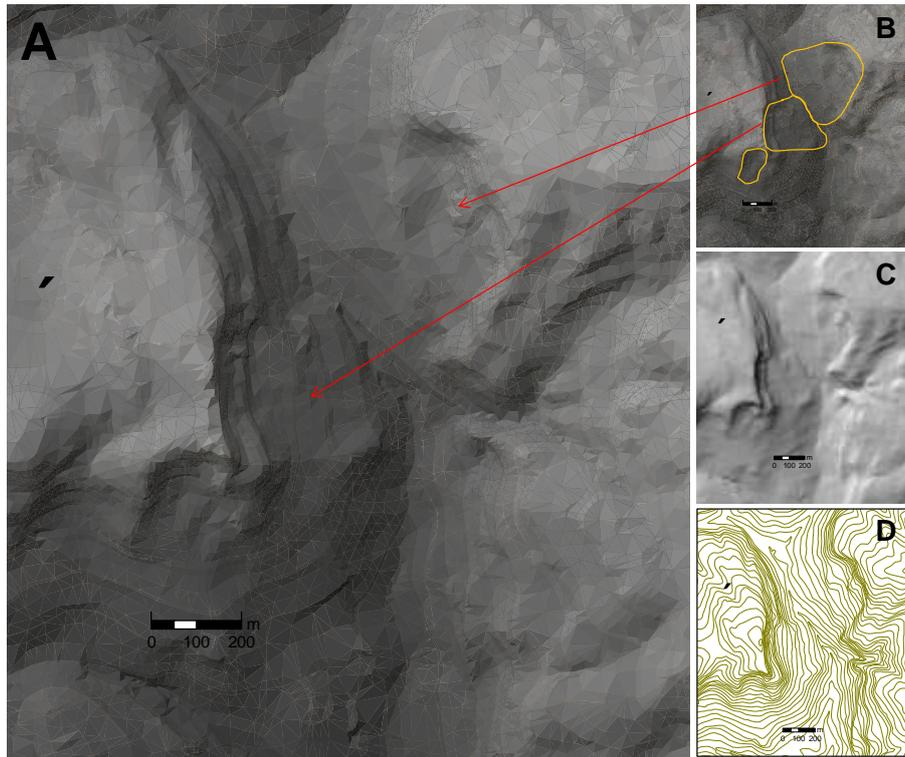
Figura 14 – Modelo Numérico de Elevación (A), relevo sombreado (hillshade)(C) y mapa topográfico (D) utilizados en la identificación del movimiento de la pendiente (B). Fuente: Oliveira (2012).
