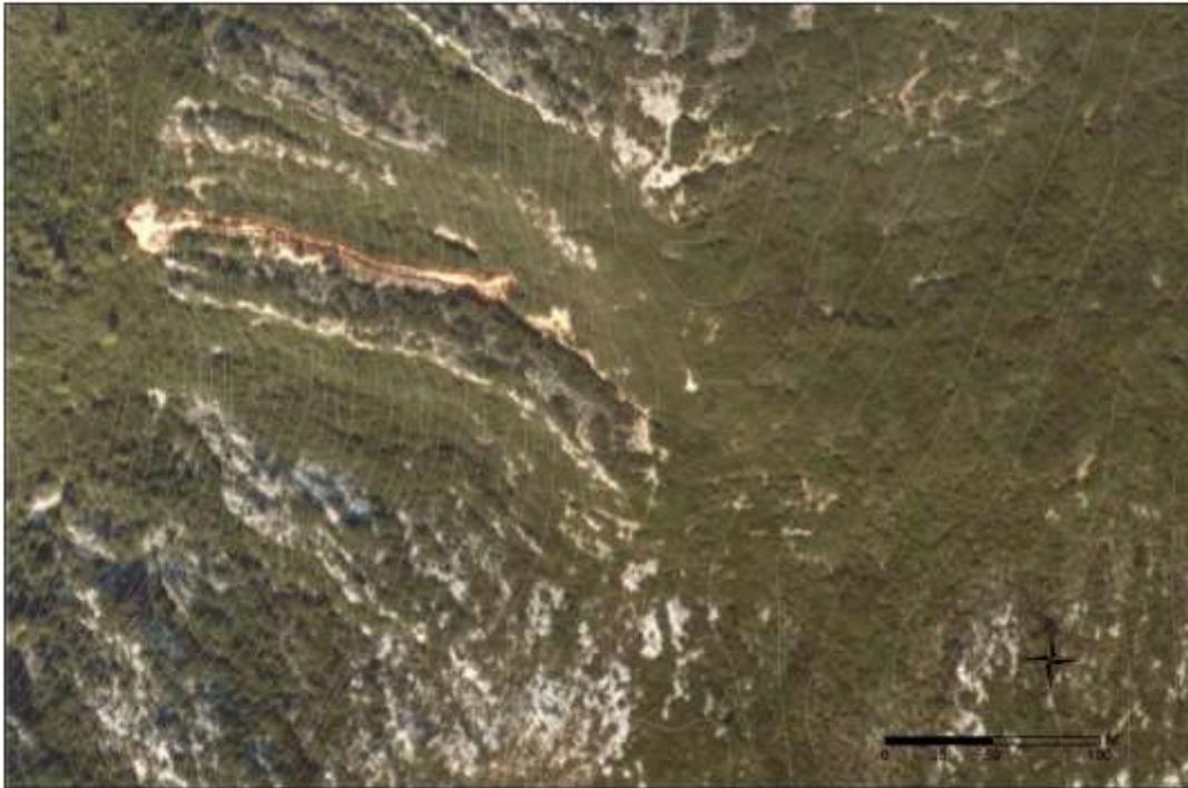
*Figura 9 - Flujo de detritos en la vertiente norte del anticlinal de Formosinho.*
