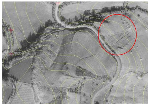
*Figura 12 – Exemplos de “falsos” elementos lineares que podem ser confundidos na fotointerpretação monoscópica com movimentos de vertente. Neste caso, pela sobreposição da altimetria facilmente se atribui o seu significado a processos de ravinamento. Fonte: Oliveira (2012).*
