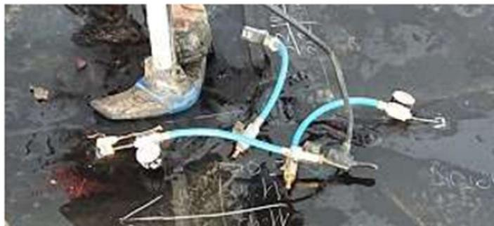
Contrôle de l'étanchéité des soudures par mise en pression
