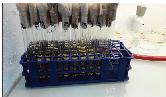
Figura 3.12. Metoda tuburilor multiple: Inocularea diluțiilor probelor în mediu specific pentru testul prezumtiv
