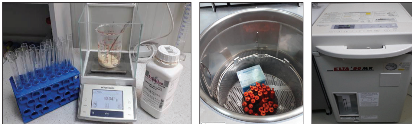
Figura 3.9. Pregătirea mediilor de cultură: cântărirea și dozarea mediilor de cultură; sterilizarea mediilor de cultură și a vârfulor de pipetă
