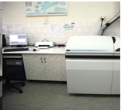
Figure 5.10. ICP - MS Elan DRCe Perkin Elmer (DDNI)
