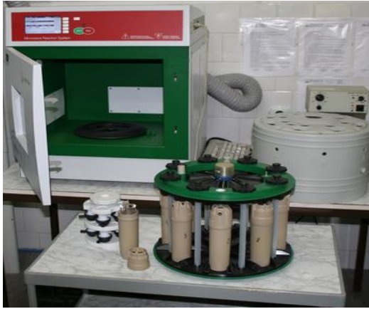
Figura 5.9. Cuptorul cu microunde Anton Paar (DDNI)
