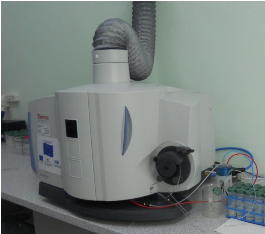
Figura 4.2. Spectrometru de emisie atomică Thermo Scientific iCAP 6200 Duo
