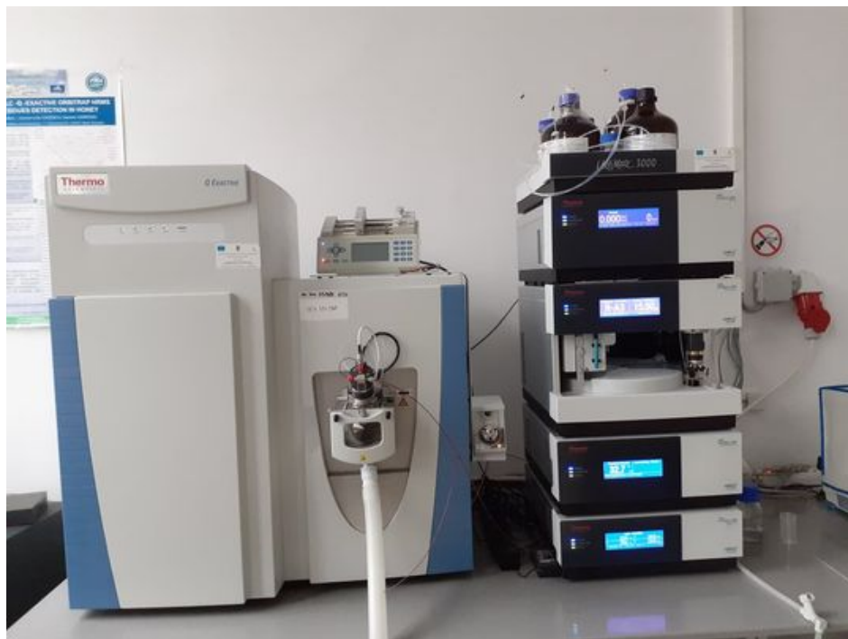
Figura 7.2. Spectrometrul de masă de înaltă rezoluție Q-Exacte Orbitrap
