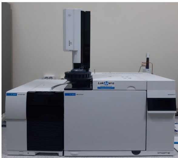
Figura 6.1. Imaginea unității GC-MS, model "Agilent 8860 GC System" cuplat cu "5977B MS Detector"
