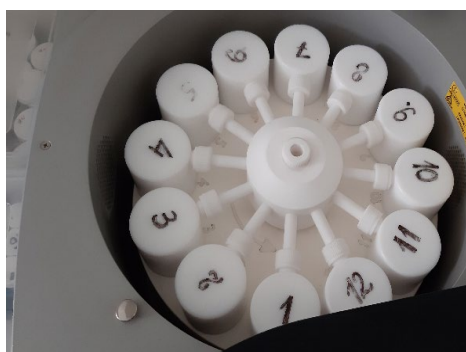
b. Digester cu microunde, pentru mostre solide și semilichide, SpeedWave four SW-4 (Berghof).
