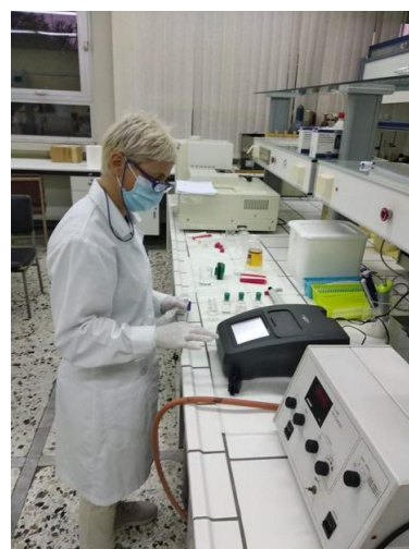
Εικόνα 2.10. Ανάλυση περιβαλλοντικών δειγμάτων με φασματοφωτόμετρο UV/Vis [15]
