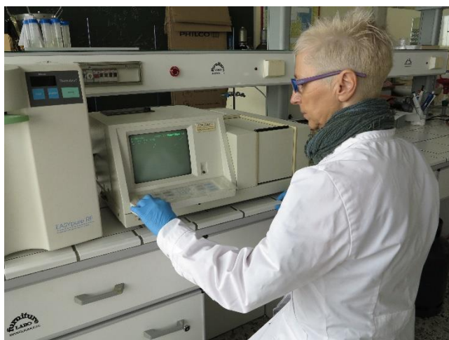
Εικόνα 2.10. Ανάλυση περιβαλλοντικών δειγμάτων με φασματοφωτόμετρο UV/Vis [15]
