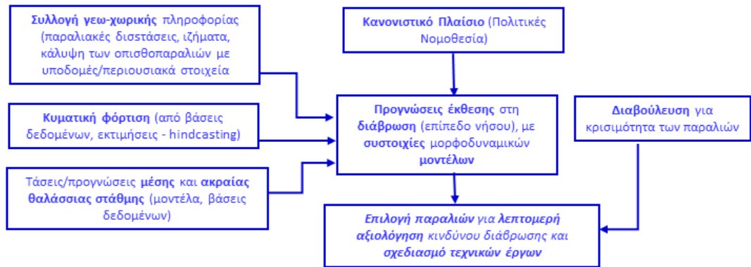
Εικόνα 1: Πρωτόκολλο, Βήμα 1: Μεθοδολογικό διάγραμμα ροής. Αξιολόγηση κινδύνου παραλιακής διάβρωσης σε επίπεδο νήσου – Επιλογή παραλιών για λεπτομερή μελέτη.
