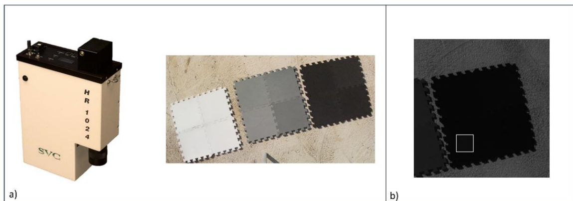
Εικόνα 2: (α) Το φασματοραδιόμετρο HR 1024 και πάνελ αφρού EVA που χρησιμοποιήθηκαν για τη βαθμονόμηση των δεδομένων του πολυφασματικού δέκτη. (β) Παράδειγμα εφαρμογής χρωματικής μάσκας στα πάνελ βαθμονόμησης.
