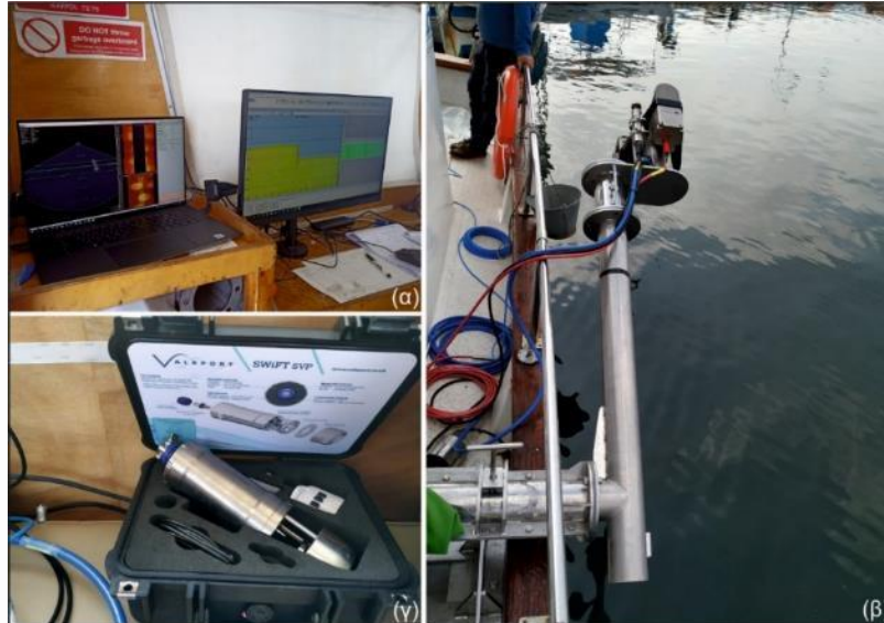
Εικόνα 12: (α) Ο υπολογιστής κατά τη συλλογή δεδομένων με το λογισμικό PDS, (β) η καταδυόμενη μονάδα του MBES στη βάση της πάνω στο Ε/Σ «Αμφιτρίτη» και (γ) το SVP.
