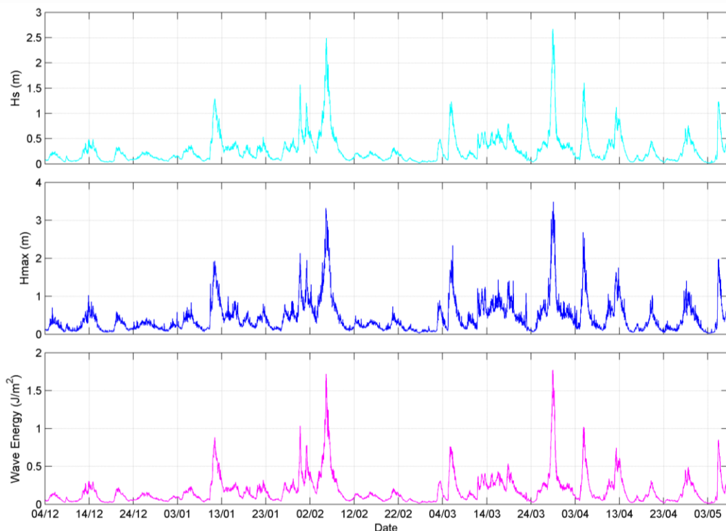
Εικόνα 75: Σημαντικό ύψος κύματος ( H_s ), Μέγιστο ύψος κύματος ( H_{max} ) και κυματική ενέργεια στην παραλία του Coral Bay, όπως καταγράφηκε από τον κυματογράφο RBR1 (σε βάθος 8.0 m).
