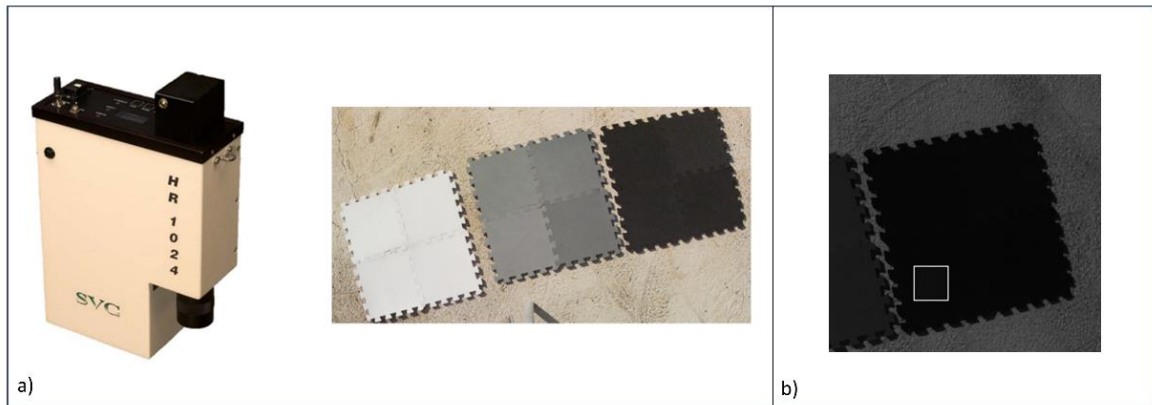
Εικόνα 9: α) Το φασματοραδιόμετρο HR 1024 και πάνελ αφρού EVA που χρησιμοποιήθηκαν για τη βαθμονόμηση των δεδομένων του πολυφασματικού δέκτη. β) Παράδειγμα εφαρμογής χρωματικής μάσκας στα πάνελ βαθμονόμησης.
