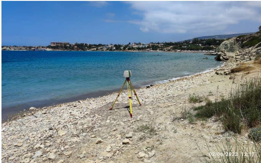
Εικόνα 13: Ο επίγειος σαρωτής laser τύπου Leica Scan Station C10 όπως αναπτύχθηκε στο Coral Bay.
