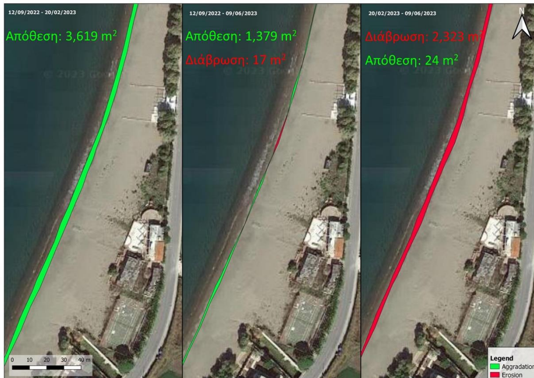
Εικόνα 41: Εκτιμώμενα εμβαδά διάβρωσης και απόθεσης μεταξύ των διαφορετικών ημερομηνιών καταγραφής της παραλιακής μορφολογίας με ΣμηΕΑ.
