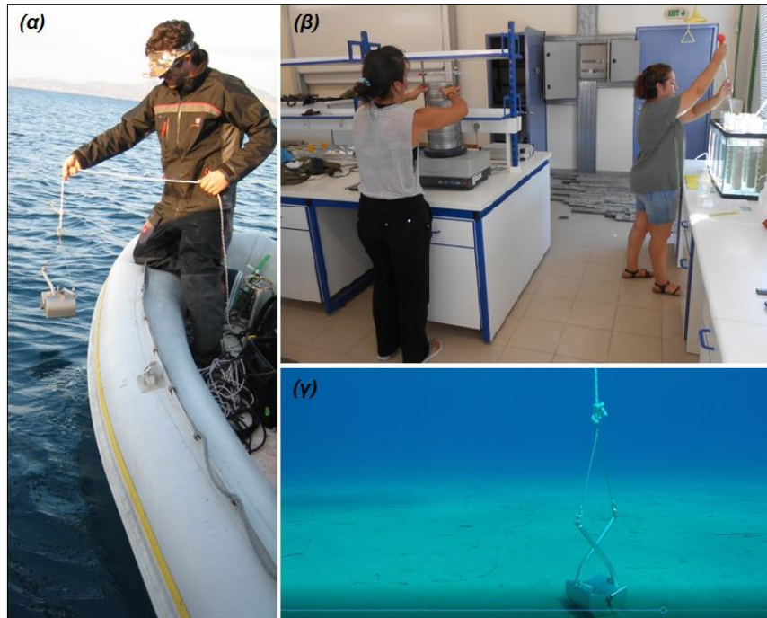
Εικόνα 25: (α) Ρήψη αρπάγης Van Veen από το φουσκωστό, (β) ανάλυση ιζημάτων στο εργαστήριο και (γ) η αρπάγη κατά τη συλλογή επιφανειακού θαλάσσιου ιζήματος.
