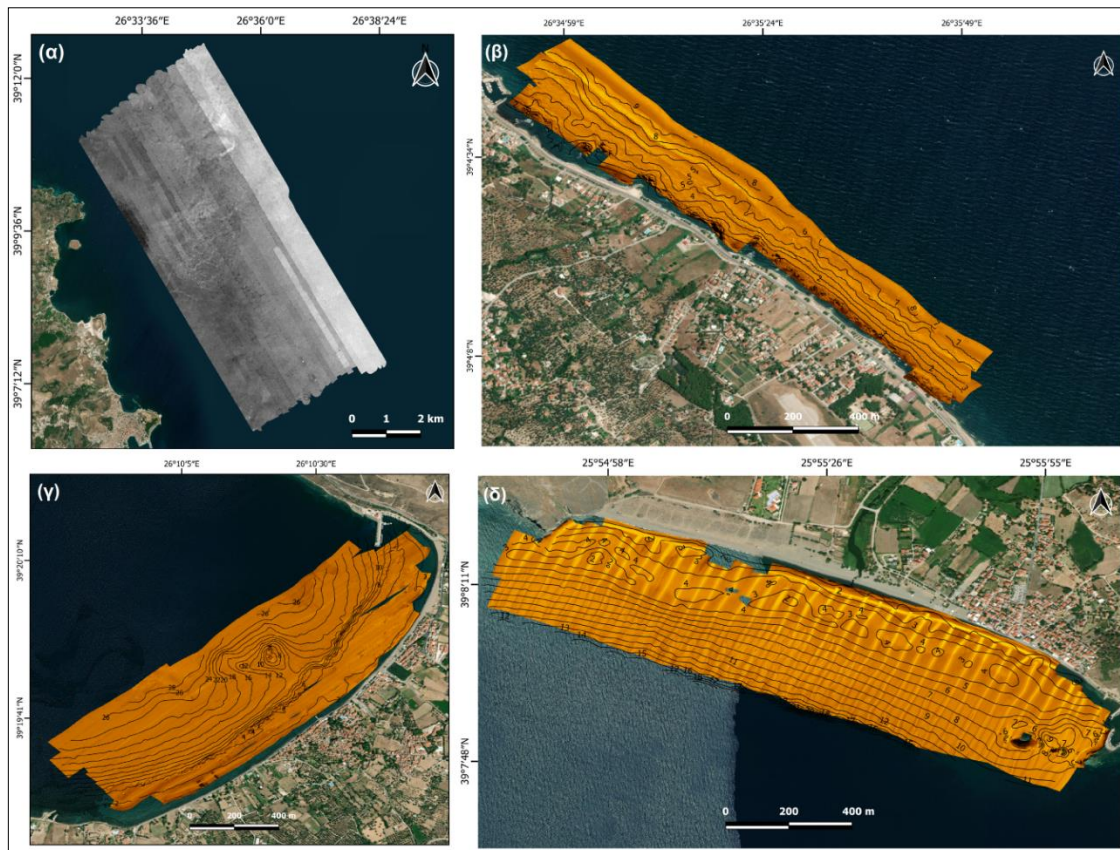
Εικόνα 20: Λέσβος: (α) Το backscatter και (β) το μωσαϊκό ηχογραφιών από την περιοχή του Στενού της Μυτιλήνης και της πράκτιας περιοχής Ιστορικού, και τα μωσαϊκά ηχογραφιών από τις περιοχές (γ) Πέτρας και (δ) Ερεσού.
