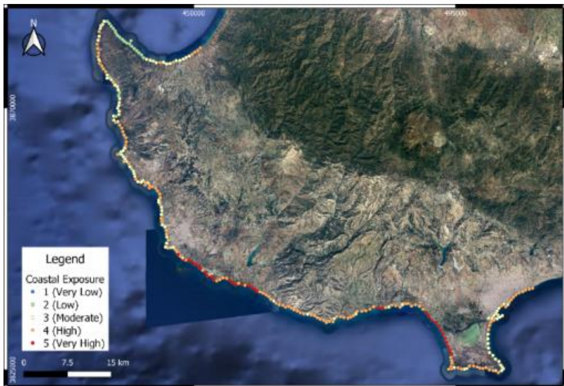
Εικόνα 70: Έκθεση της ακτογραμμής σύμφωνα με τον δείκτη τρωτότητας συμπεριλαμβανομένης και της επίδρασης των φυσικών οικοτόπων.
