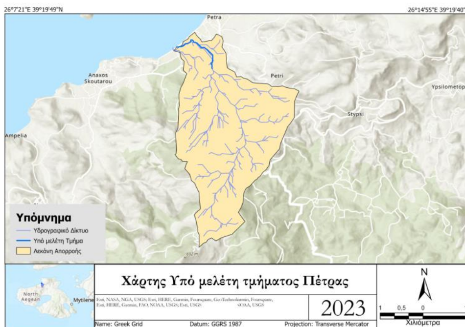
Εικόνα 15: Το κύριο τμήμα του υδρογραφικού δικτύου της λεκάνης, καθώς και ο κλάδος του υδατορεύματος που λαμβάνεται υπόψη κατά την υδραυλική προσομοίωση (υπό μελέτη τμήμα).
