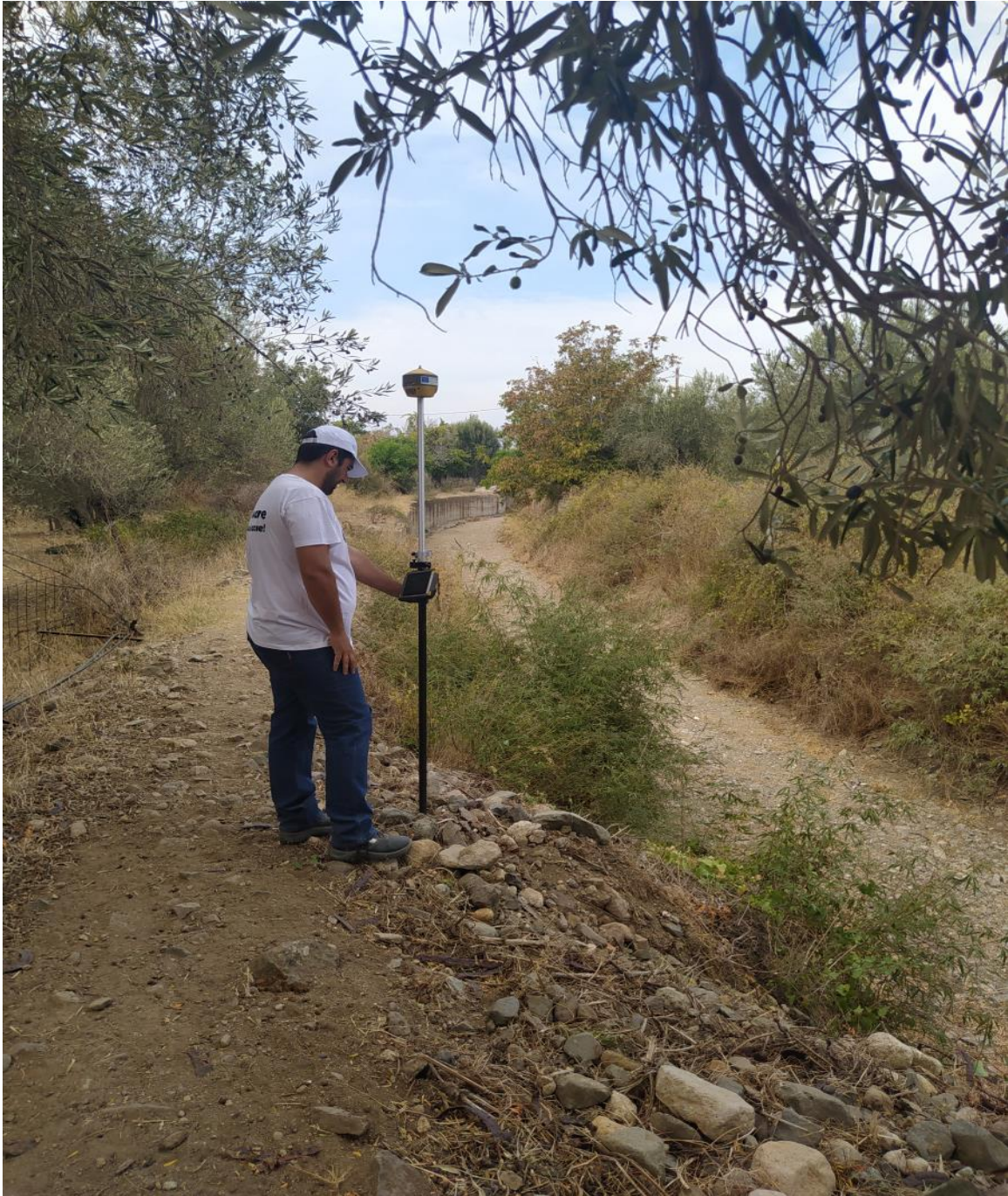
Πέτρα – μετρήσεις πεδίου με τον επίγειο δέκτη GNSS-GPS
