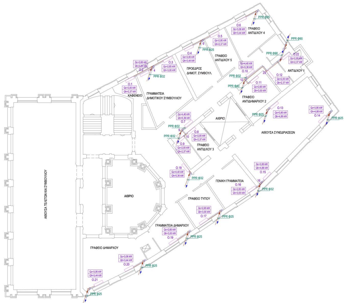
Σχήμα 29γ: Δίκτυο κλιματισμού – κάτω όροφος.
