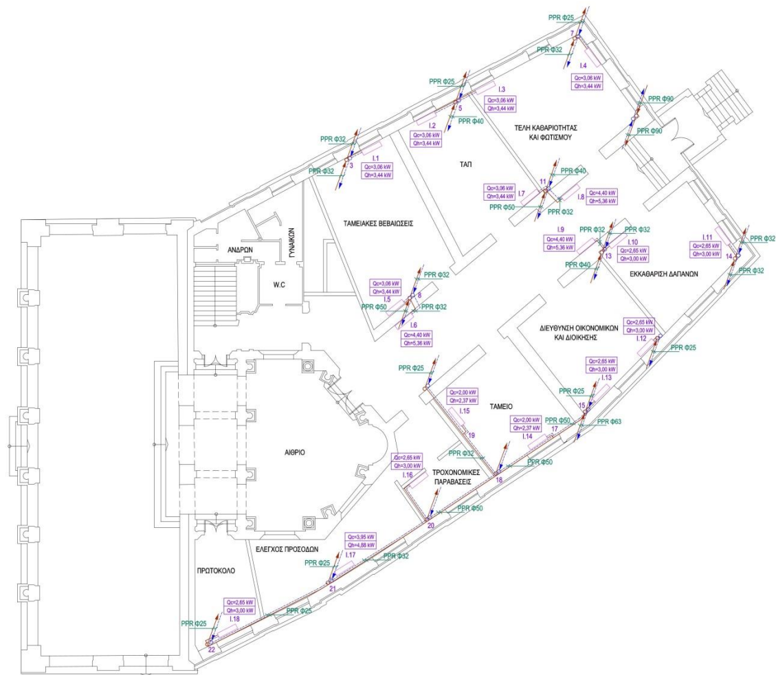
Σχήμα 29β: Δίκτυο κλιματισμού – κάτοψη ισογείου.
