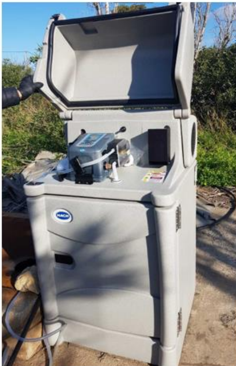
Εικόνα 07: Αυτόματος δειγματολήπτης 24ώρου για δειγματοληψία στην είσοδο της κεντρικής ΕΕΛ ΔΕΥΑΗ
