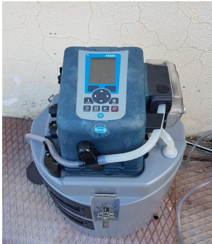
Εικόνα 06: Αυτόματος δειγματολήπτης 24ώρου για δειγματοληψία στο ΠΑΓΝΗ
