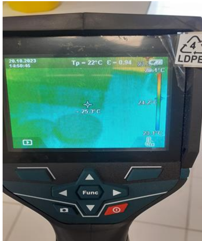
Εικόνα 78: Θερμική κάμερα φάσματος ψηφιακής απεικόνισης της κατανομής των θερμικών φορτίων
