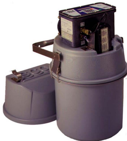
Εικόνα 2-7: Αυτόματος φορητός δειγματολήπτης παθητικής ψύξης
