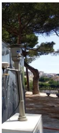
Figure 4.1.2: Echantillonneur gravimétrique Digitel sur le site de San Teodoro (à gauche) et de Corso Firenze (à droite) pour les campagnes expérimentales.
