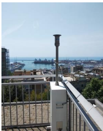
Figure 4.1.2: Echantillonneur gravimétrique Digitel sur le site de San Teodoro (à gauche) et de Corso Firenze (à droite) pour les campagnes expérimentales.
