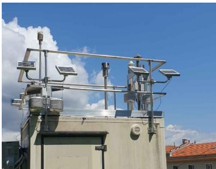
Figure 3.5.4: Comparaison \mu Capteurs NO 2 avec station de référence Canetto.
