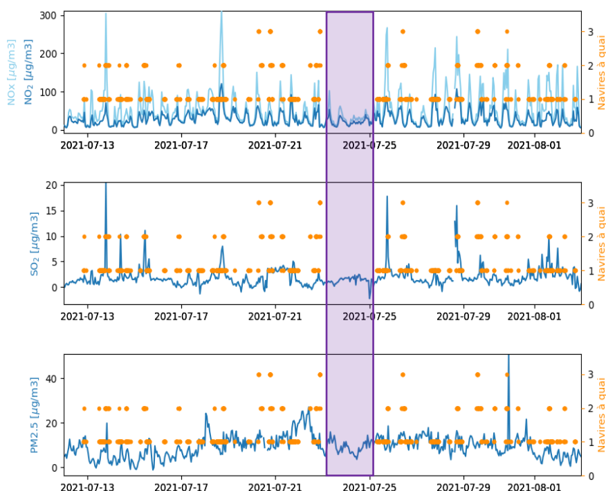
Figure 5.4.1: Concentrations horaires en \text{NO}_2 , \text{NO}_x , \text{SO}_2 et \text{PM}_{2.5} (lignes bleues) mesurées à la cabine Toulon TCA entre le 12/07/21 et le 03/08/21, comparées au nombre de navires à quai (points oranges) lorsque les vents ont une direction comprise entre 200^\circ et 260^\circ . Les données de présence des navires ont une précision temporelle de 5 minutes
