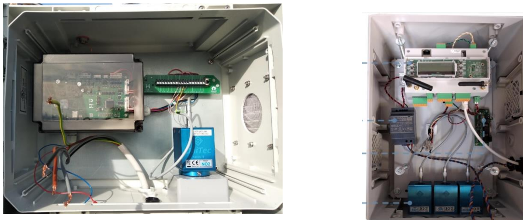
Figure 3.1.1: Enregistreur de données ACRONET et Enregistreur de données ZENO.
