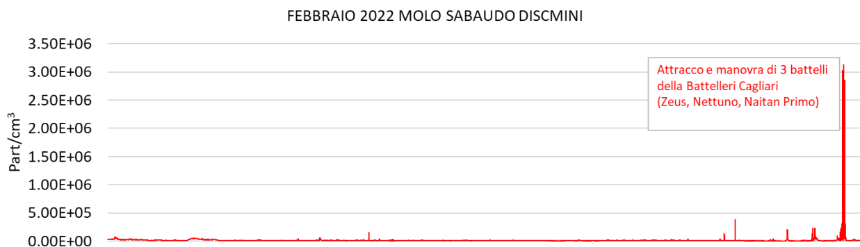
Figure 4.2.35: Variation temporelle des concentrations numériques de particules ultrafines (UFP) ( \text{Part}/\text{cm}^3 ) mesurées par le compteur personnel de particules DiSCmini pendant la campagne d'hiver dans le port de Cagliari.
