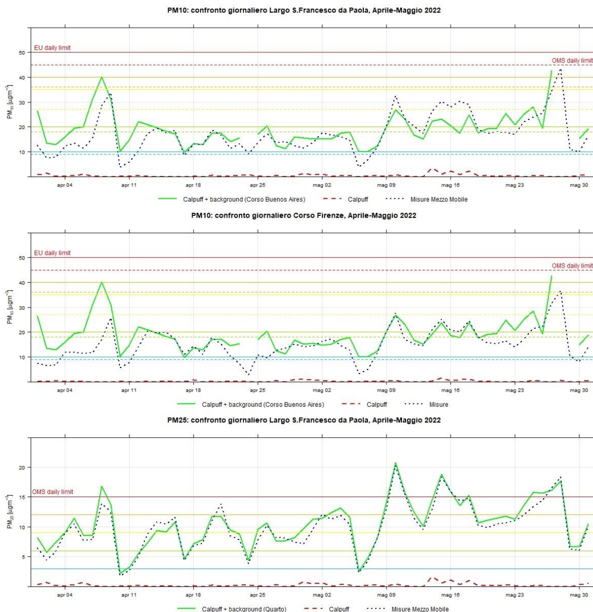
Figure 62 : Comparaison à l'échelle journalière entre les simulations et les observations de PM_{10} et PM_{2.5} pour la deuxième campagne de mesures
