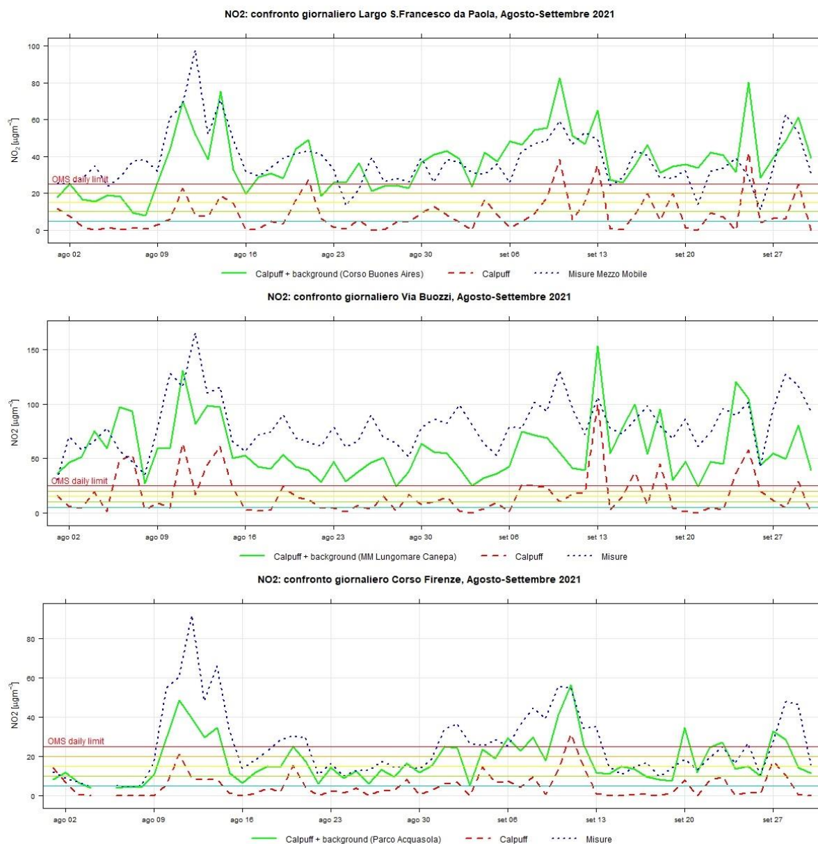
Figure 59 : Comparaison à l'échelle journalière entre les simulations de NO 2 et les observations de la première campagne de mesure
