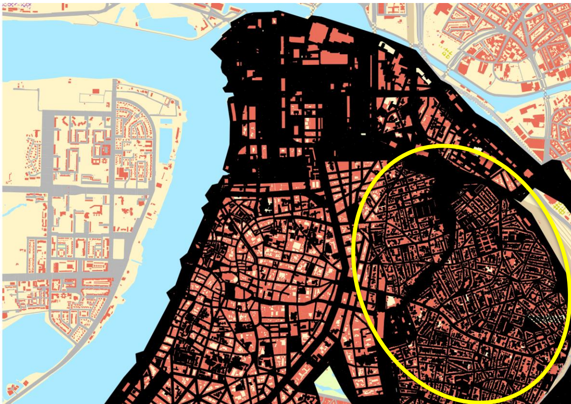
Afbeelding 1 Verskil tussen 2D mesh voor rioolmodel Antwerpen en voor rioolmodel Deurne (gele cirkel). Zwarte zones zitten vervat in de gebruikte 2D mesh.
