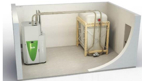
Figuur 69 - Principeschets pelletketel met silo (bron: ökofen)
