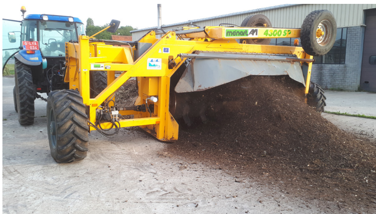
Figuur 9: Stem de aankoop van een compostkeerder af op de grote van de ril. Een te grote keerder is moeilijk manoeuvreerbaar en er volgt veel opkuiswerk na het keren. Ideaal is de keerder gecombineerd met een waterreservoir (Bron rechterfoto: apfuchs.cz).
