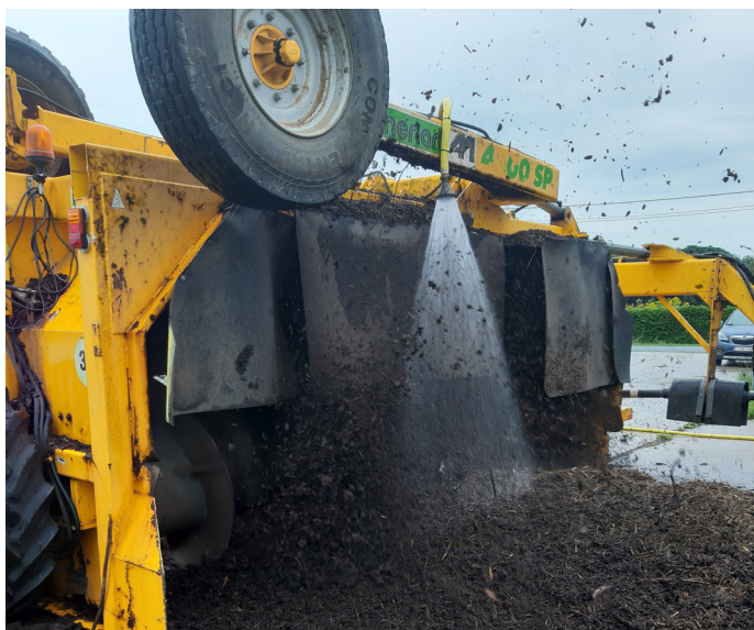
Figuur 4: Watertoevoer gebeurt het efficiëntst tijdens het keren
