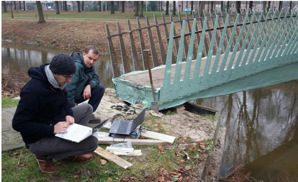
Afbeelding 69 In Situ meten van de rekken in de glasvezels
