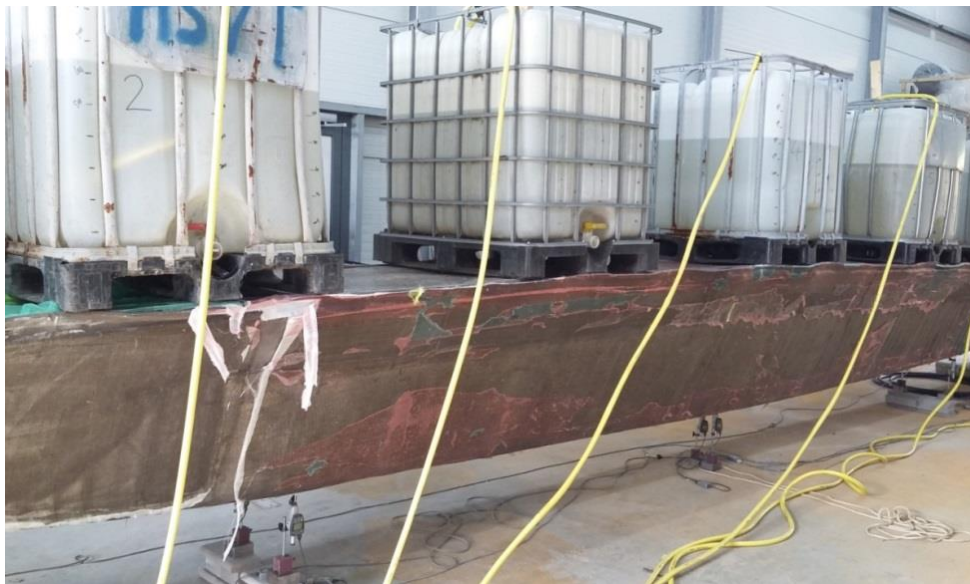
Afbeelding 68 Tijdens de belastingtest werd uiteindelijk 500 kg per m 2 belasting (in water) op de brug gezet. Doorbuiging in de midden ten gevolge van deze belasting bedroeg uiteindelijk ca. 35 mm
