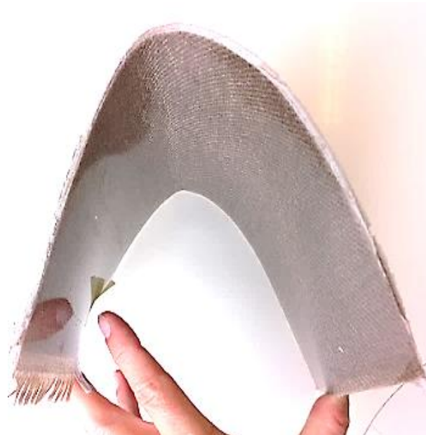
Afbeelding 38 Resultaat (onverwacht) van een reactie met Biothan en vlasmat. De cellulosecomponent in het vlas heeft gereageerd met de isocyaanaat harder
