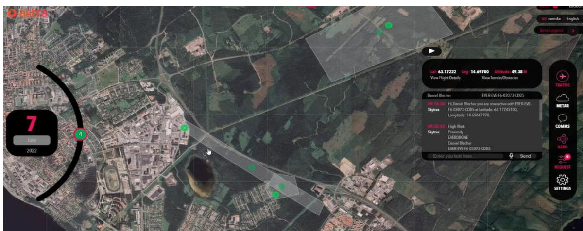
Figur 19 – Astras UTM-system från tester i Östersund med tre drönare i luften.
