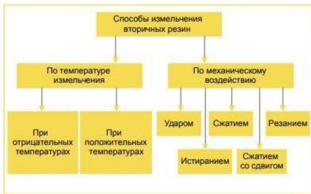
Рис.3. Способы измельчения шин
