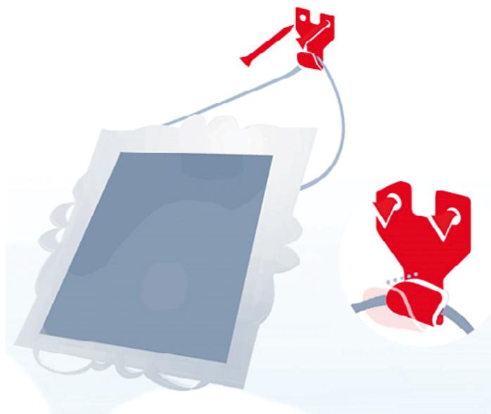
Figura 15. Suportes de fixação de objetos suspensos (fonte: *Guia Prático KnowRISK*, Ferreira *et al.*, 2017).
