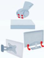
Segurar equipamentos com cintas. Usar adesivos e lapetes anti-derrapantes. Usar estores ou película em vidros.
