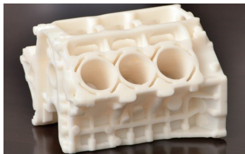
Peza fabricada mediante tecnoloxía de impresión 3D SLA
