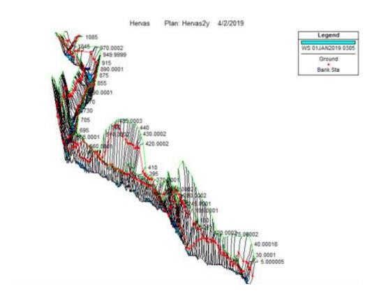
Como primer paso la realización de las simulaciones bidimensionales en régimen variable el programa HEC-RAS necesita una descripción de la geometría del terreno incluyendo el cauce del río, las secciones transversales, las líneas de flujo, etc. Esta información fue obtenida mediante el programa ARCGIS y el módulo de cálculo Geo-RAS a partir del modelo digital del terreno de resolución 25m (MDT25) suministrado por el instituto geográfico nacional.
