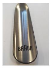
Der zweite von uns entwickelte Prototyp wird mit einer Kombination aus Stanztechnik und Kunststoffspritzguss hergestellt. Wegen des Designs haben wir rostfreien Stahl verwendet. Das aufgedruckte Logo muss Druck- und Kratztests standhalten.
