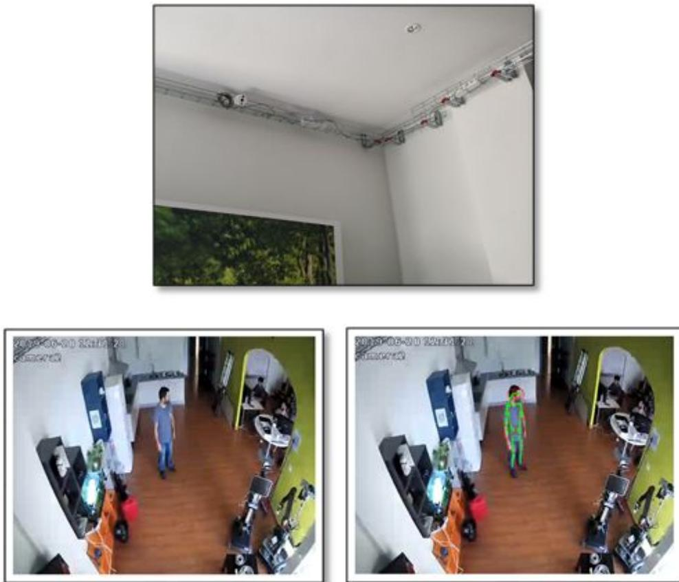
Fig. 11. Vista parcial del aLab (arriba). Imágenes capturadas por el sistema de percepción y resultados del algoritmo de detección de la posición y postura de la persona mayor.
