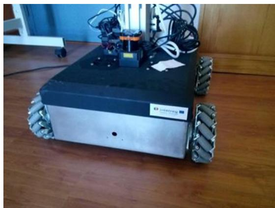
Figura 2. Vista parcial del robot Viriato y su base omnidireccional.
