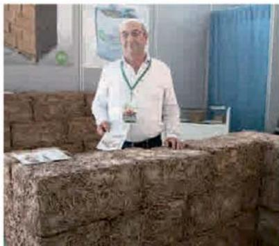
**VUELTA AL ADOBE.** El constructor riojano Manuel Rodríguez Barriero propone bloques aligerados de tierra y paja para una bioconstrucción sostenible. Su aislamiento térmico y su flexibilidad ante movimientos sísmicos son dos de sus cualidades destacadas. | JAVIER DE LA FUENTE
