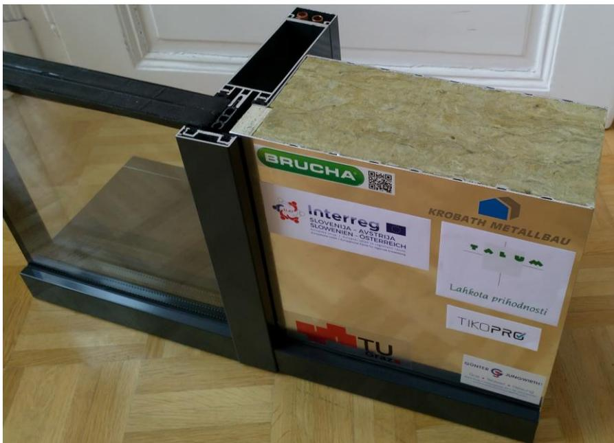
Abbildung 3: In ein Pfosten-Riegelsystem integrierter Prototyp des STAF-Paneels
