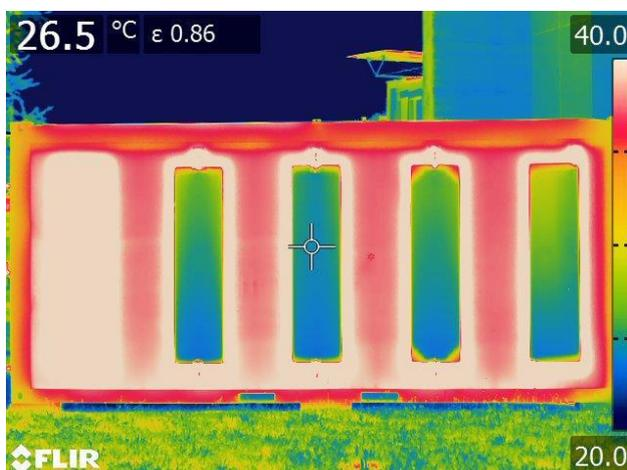
Abbildung 7: Thermografische Aufnahmen des Prüfstandes der STAF-Paneele an der Technischen Universität Graz
