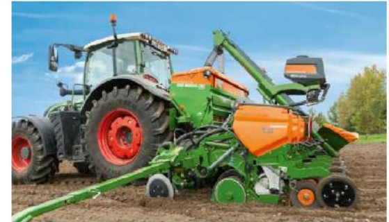
Amazone ED mit Unterfußdüngung und Mikrogranulatdosierer
