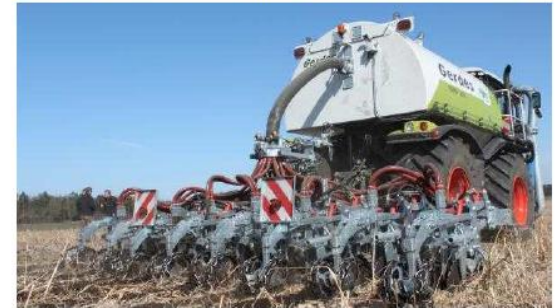
Vogelsang Xtill bei der Gülleeinbringung
