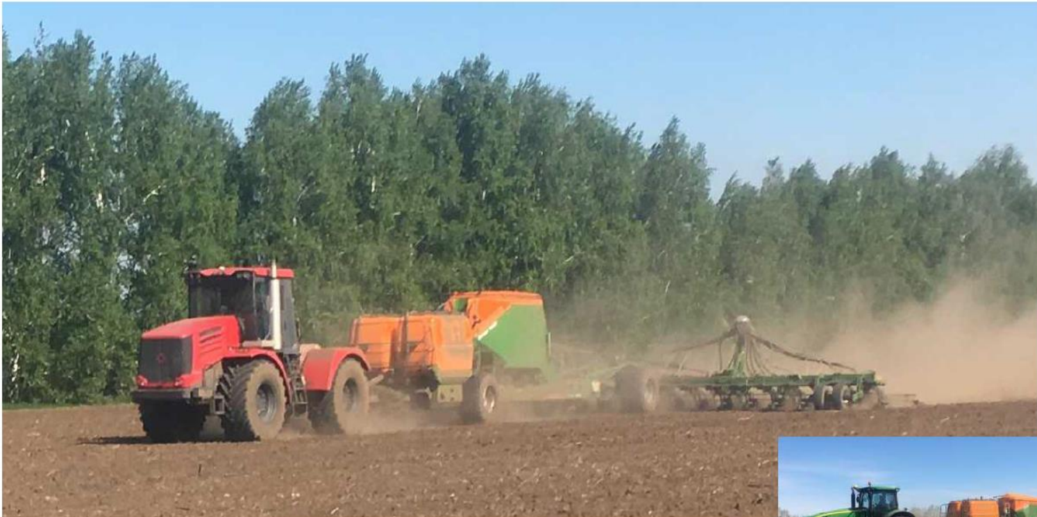
Getreideaussaat mit Condor 15001 mit 6000 Liter Flüssigdüngerkart
