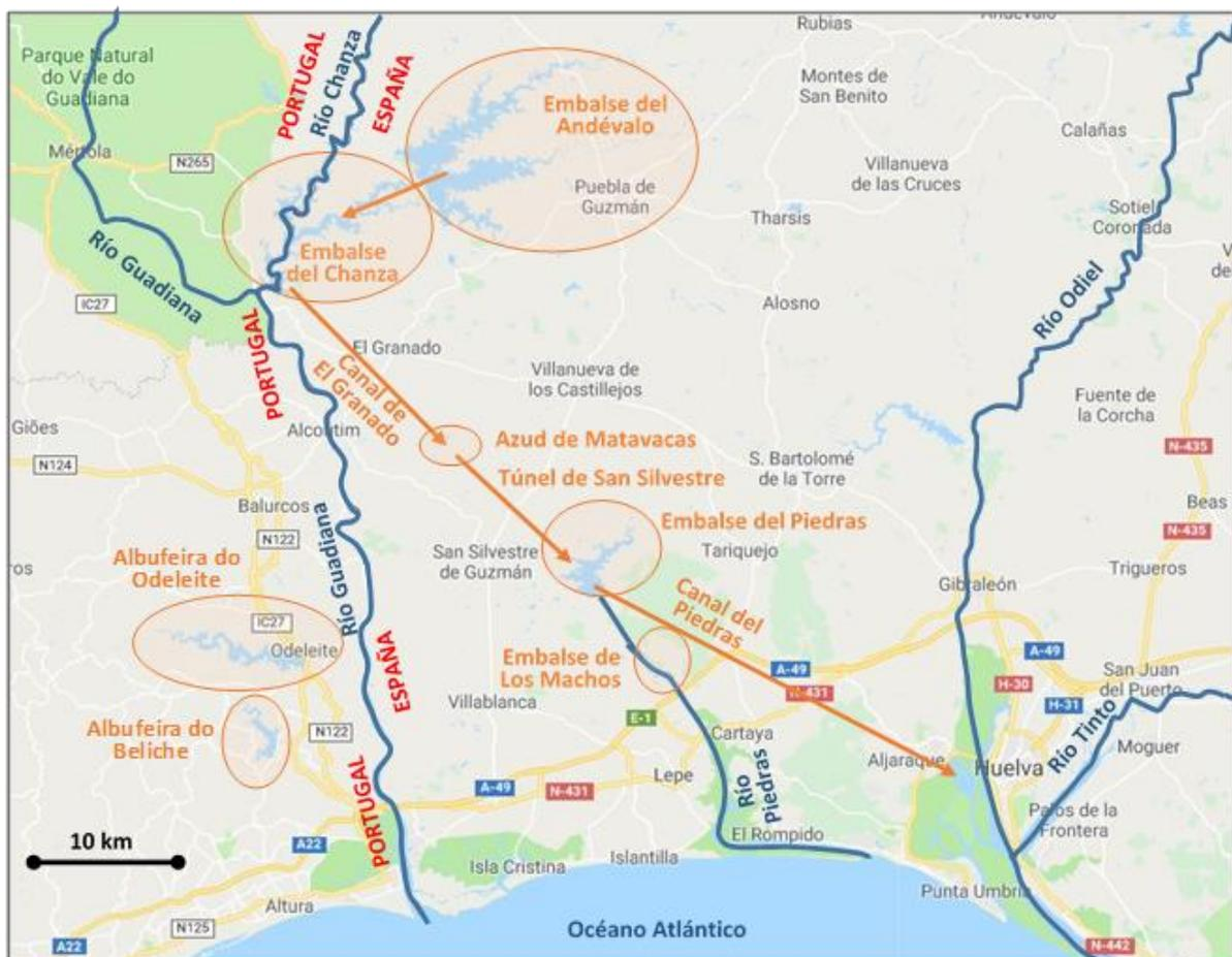
**Figura 2.** Esquema hidráulico del sistema de regulación Chanza-Piedras-Huelva (demanda consolidada de agua que se transfiere a la Demarcación Hidrográfica Tinto-Odiel-Piedras)
