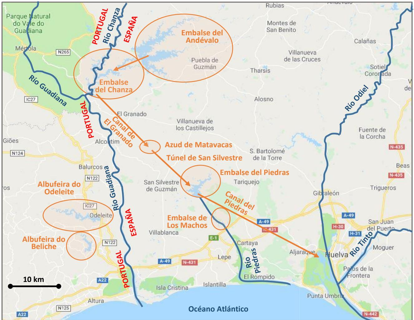
**Figura A1.1.** Esquema hidráulico del sistema de regulación Chanza-Piedras-Huelva (demanda consolidada de agua que se transfiere a la Demarcación Hidrográfica Tinto-Odiel-Piedras)
