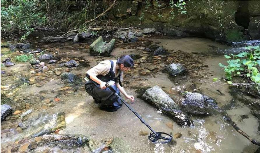
**Figura 27.** Detección de marcas PIT con el detector de metales aguas abajo de la escala.
