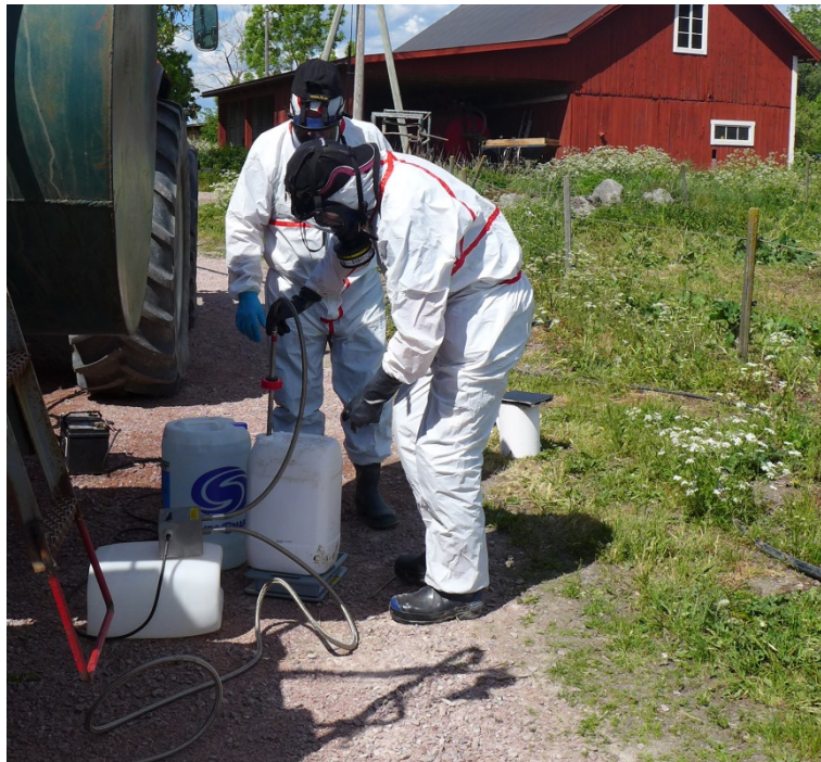
Figur 2. Försökspersonal iklädda skyddsutrustning vid hantering av svavelsyra.
