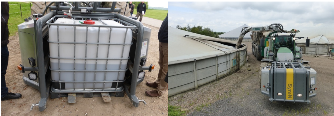
Figur 6. Mobil tank av typ "intermediate bulk container" (IBC) i kassett, öppen (till vänster) och försluten (till höger) (Fabrikat BioCover A/S).
