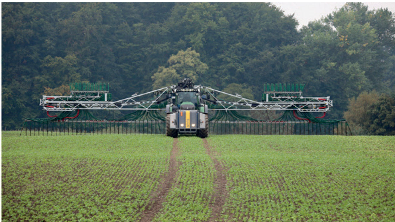
Happokäsittely on EU:n hyväksymä BAT sikojen tehotuotannossa ja täten sisällytettävissä ympäristöluvan ehtoihin direktiivisikaloilla, joita Suomessakin on 102 kpl (2015) sekä muillakin ympäristöluvan vaativilla sika- ja karjatiloilta. Kuvassa Blunk GmbH:n SyreN laitteisto ja letku-levitin 36 metrin työleveydellä.
