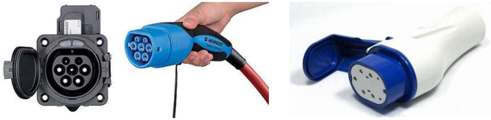
Enchufes tipo 2 (izda.) y tipo 3-c (dcha.)
