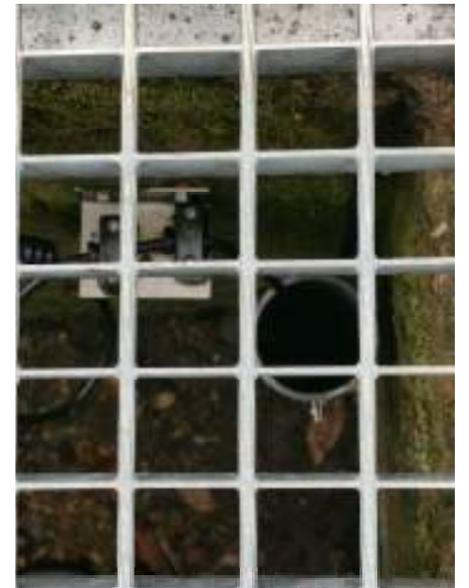
La presión de la columna de agua será aplicada a la capsula de forma directa, mediante inmersión, por lo que se exige instalar un tubo de PVC de diámetro interior no menor de 65 mm para que sea fácil la extracción del sensor para su mantenimiento.
