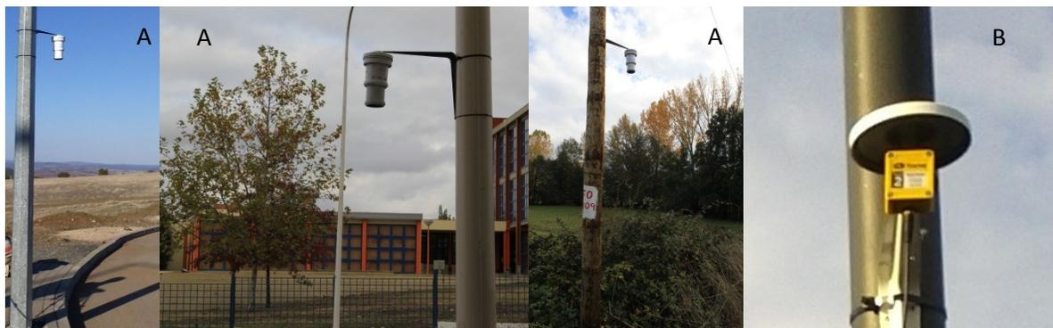
**Figura 14** - Locales con monitorización de la temperatura y humedad relativa (A); detalle del sistema de medición sin el abrigo (B)
