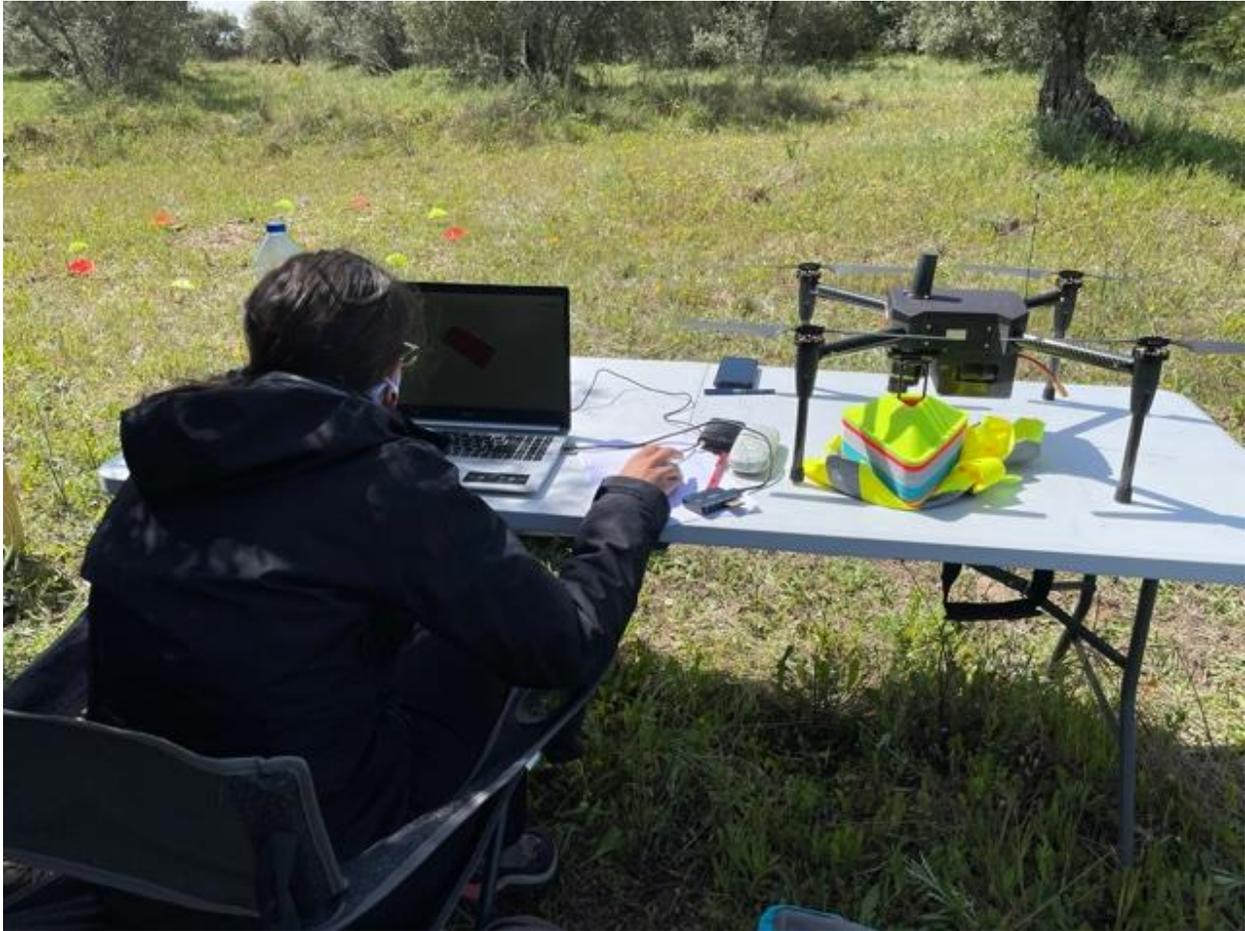
*Figura 14 Campaña de toma de imágenes con un drone equipado con cámaras multiespectral y térmica. Los sistemas actuales tienden a la interoperabilidad y miniaturización de los sensores.*
