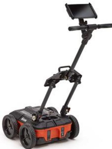
Fig. 3.3 - Geo-radar. Fuente: GSSI
