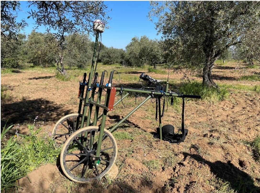
*Figura 15 Gradiómetro multicanal con conexión GPS. Este tipo de sistemas permiten capturar un gran volumen de datos con georeferenciación en tiempo real.*
