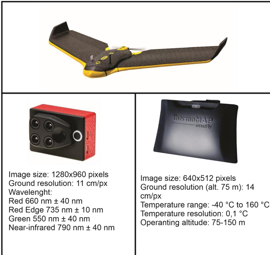
*Figura 27. Características técnicas de los sensores utilizados en el caso de estudio de Guadajira para el trabajo de teledetección. Arriba: drone de ala fija sistema Ebee. Izquierda: cámara multiespectral. Derecha: cámara térmica.*
