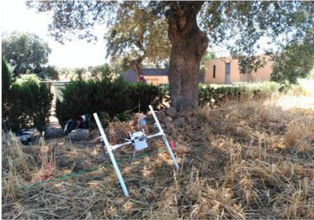
*Figura 16 Gradiómetro GRAD 601 (Bartington)*
