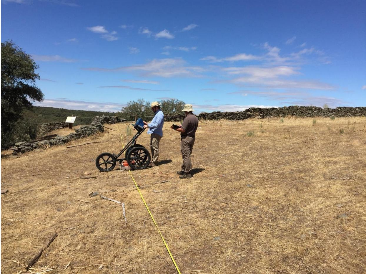
*Figura 24 Ejemplo de toma de datos con georradar monocanal empleando como referencia para los recorridos una rejilla planteada sobre el terreno.*
