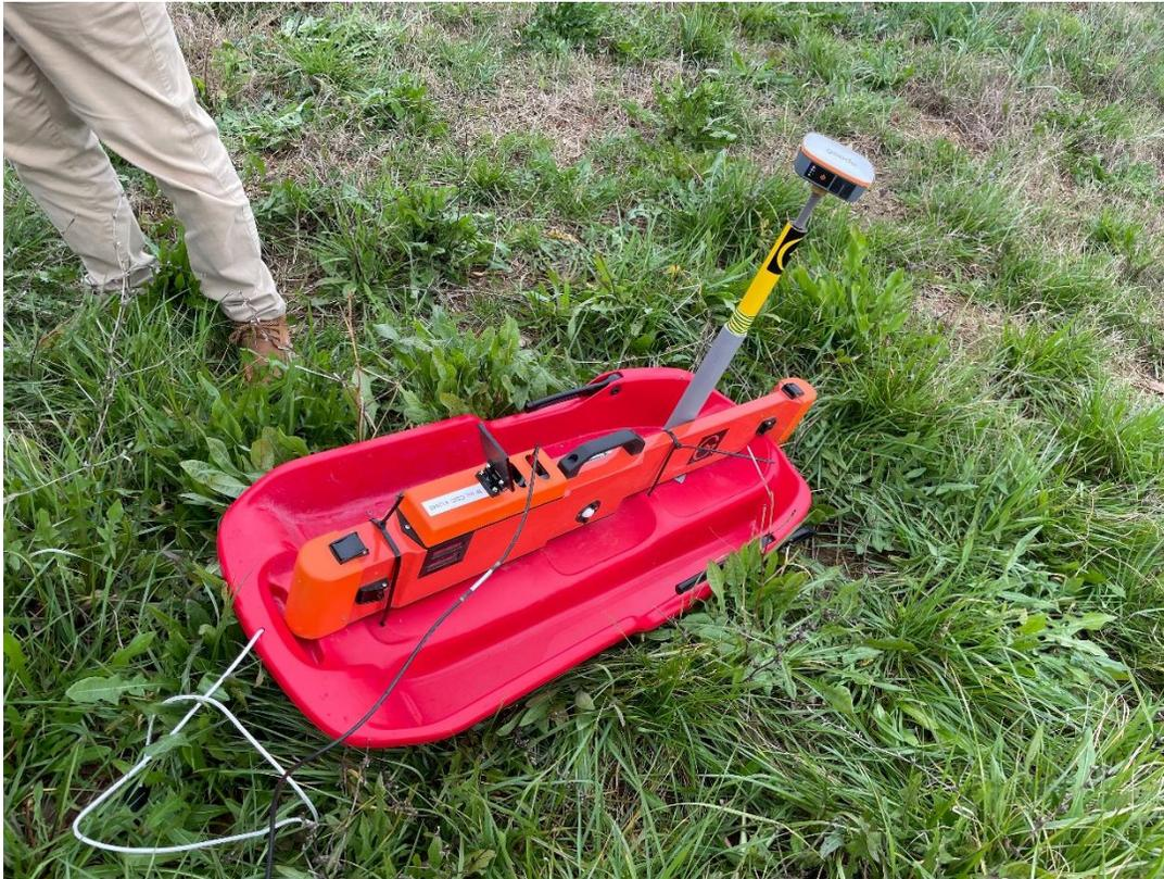
*Figura 5 Implementación de un sistema para la toma de datos con el EM38 mediante tracción, que permite evitar el efecto del cabeceo del sensor y mantenerlo paralelo al terreno*
