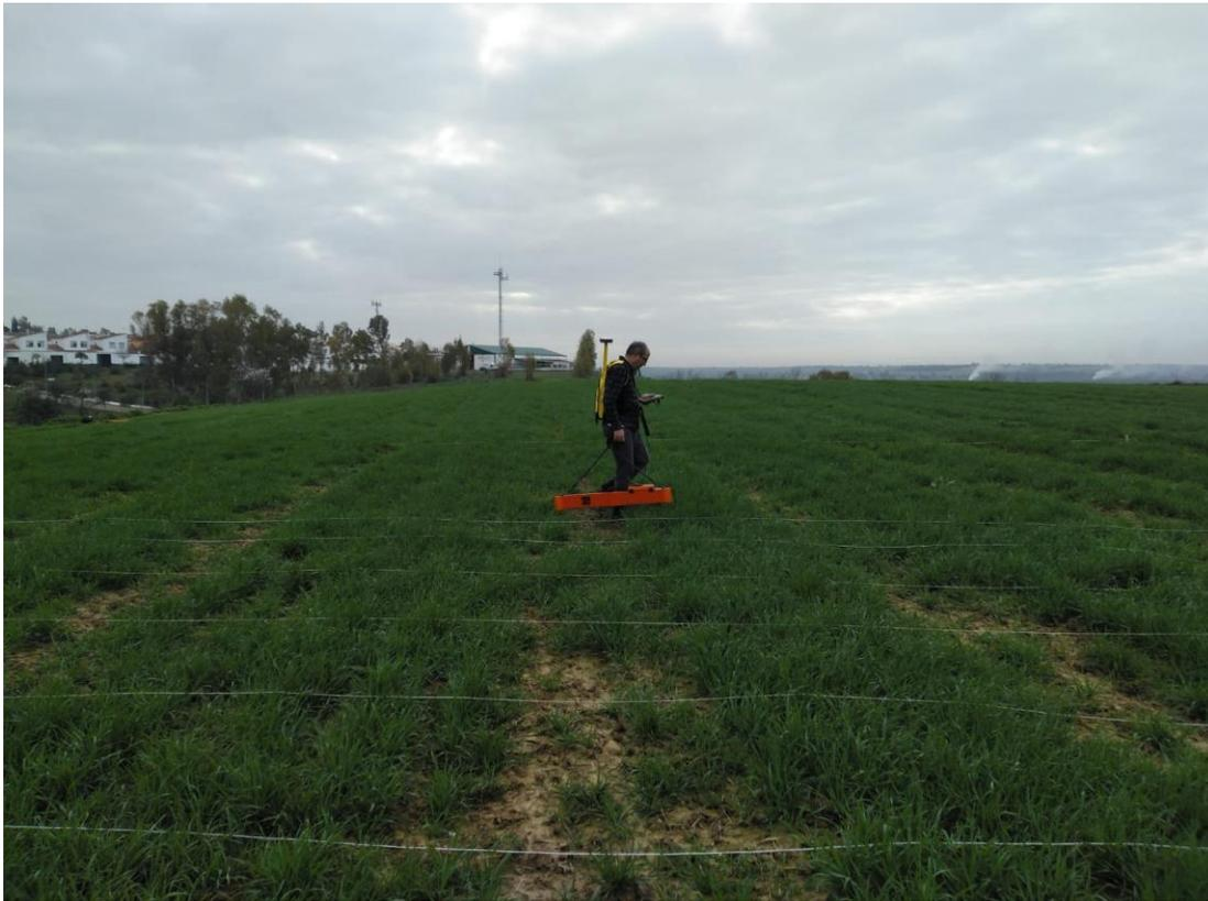
*Figura 3 Toma de datos con el EM38 empleando como referencia una malla con espaciado de 1 metro. Pese a contar con la georreferenciación en tiempo real gracias al protocolo NMEA, es fundamental para obtener un buen resultado una cobertura lo más homogénea y regular posible.*
