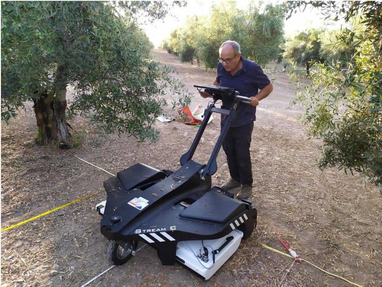
*Figura 7 Georadar multicanal modelo IDS Stream C perteneciente al Instituto de Arqueología. Este tipo de sensores permite obtener barridos de alta densidad capaces de definir con gran resolución los restos enterrados.*
