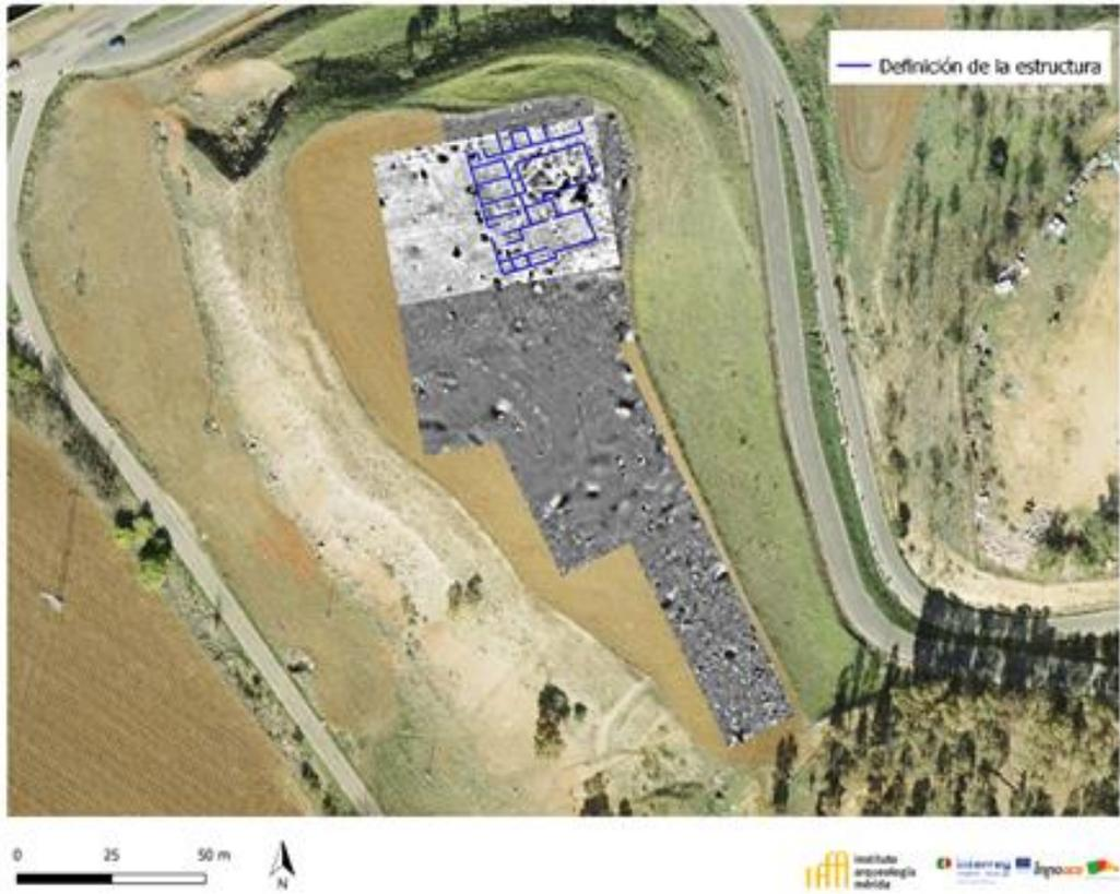
Figura 28 Prospección magnética con el GRAD601 y delimitación de la estructura identificada
