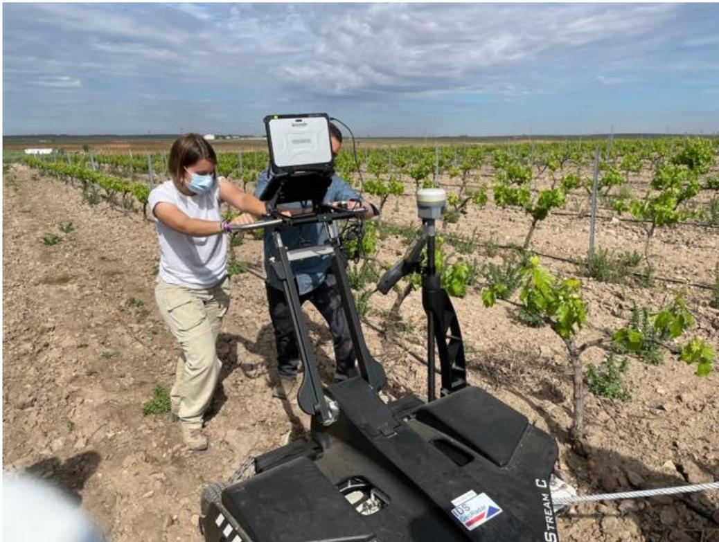
*Figura 22 Georradar multicanal trabajando con georeferenciación en tiempo real gracias a la conexión del equipo con un sistema GNSS.*
