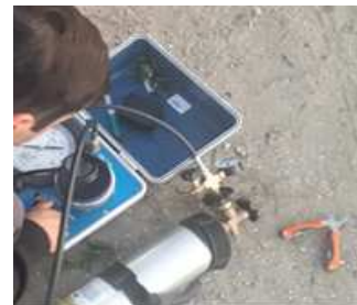
Figura 7 - Leitura na câmara de pressão de Scholander.
