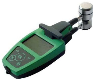
Figura 9. Medidor de carotenoides, antocianos y clorofilas (foto izquierda) y su utilización sobre el cultivo.
