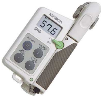
Figura 6. Medidor de clorofila Spad Minolta 502 (foto izquierda) y ejemplo de medida en ciruelo japonés (foto derecha).
