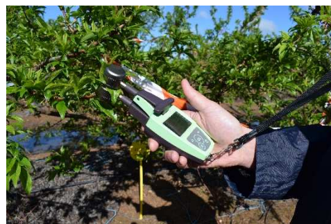
Figura 9. Medidor de carotenoides, antocianos y clorofilas (foto izquierda) y su utilización sobre el cultivo.
