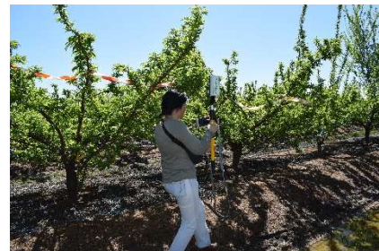
Figura 8. Medidor de reflectancia Crop Circle ACS470 (foto izquierda) y su utilización sobre el cultivo del ciruelo japonés (foto derecha).
