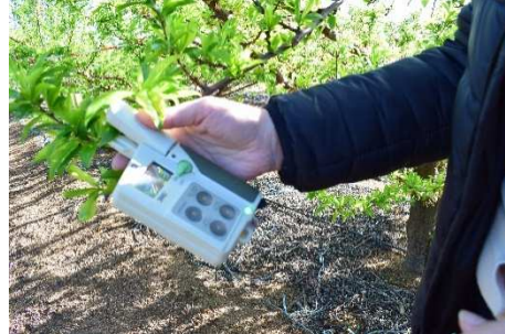
Figura 6. Medidor de clorofila Spad Minolta 502 (foto izquierda) y ejemplo de medida en ciruelo japonés (foto derecha).
