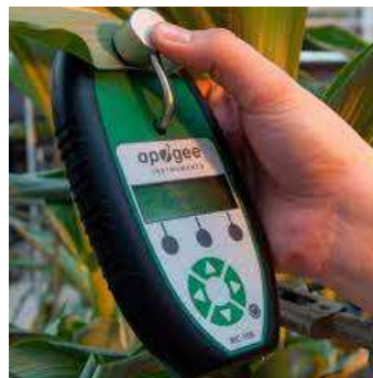
Figura 7. Medidor de clorofila Apogee MC-100 (foto izquierda) y ejemplo de medida (foto derecha).
