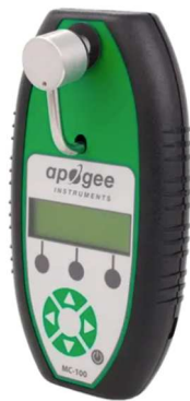
Figura 7. Medidor de clorofila Apogee MC-100 (foto izquierda) y ejemplo de medida (foto derecha).
