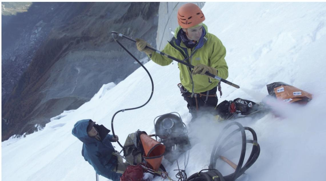
Figure 8 – Mise en place d'une ligne de capteurs de température dans l'un des glaciers suspendus de l'Aiguille du Midi (Chamonix, Fr). Un capteur de température implanté dans le rocher, complète le dispositif.
