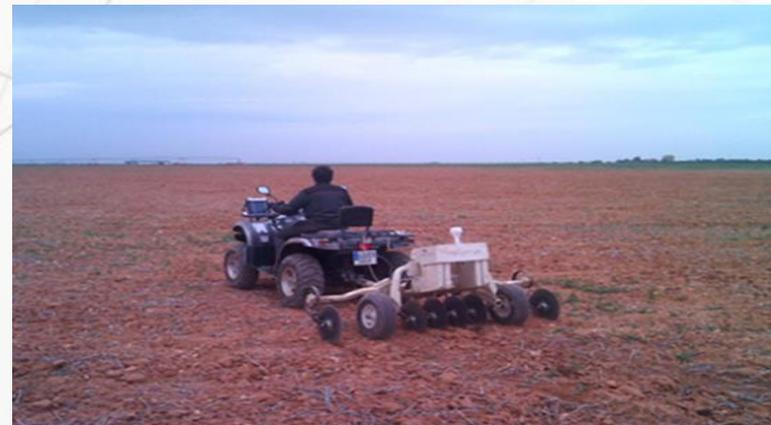
Sonda de suelo montada en quad para la medición de la conductividad eléctrica aparente del suelo.
