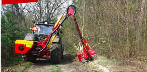
**Figura 3 - Grua articulável com cabeça destroçadora para limpeza de taludes. Da empresa italiana Seppi m.**
