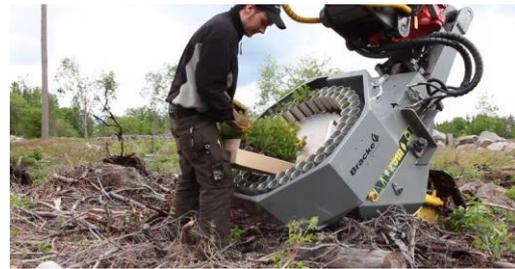
**Figura 24 - Bracke P11.a, mecanismo plantador desenvolvido pela empresa Bracke Forest.**
