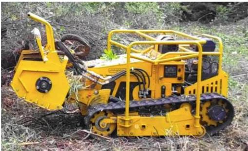
**Figura 4 - PICO robô de desmatção da empresa portuguesa Unmanned Tools -UT.**
