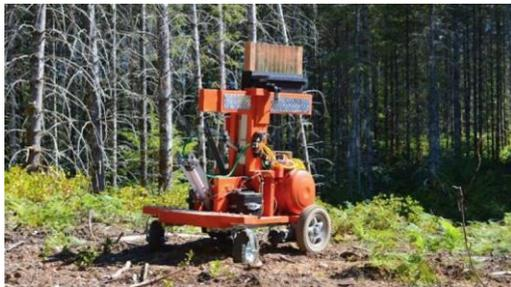
**Figura 26 - TreeRover. Robô plantador desenvolvido na Universidade de Victoria.**
