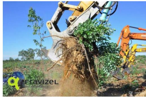
**Figura 23 - Rachador arranca cepos patenteado e produzido pela empresa portuguesa Fravizel.**
