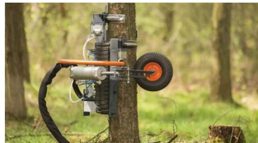
**Figura 6 - Mecanismo teleoperado para a operação de desramação. Produzido pela empresa Advaligno.**
