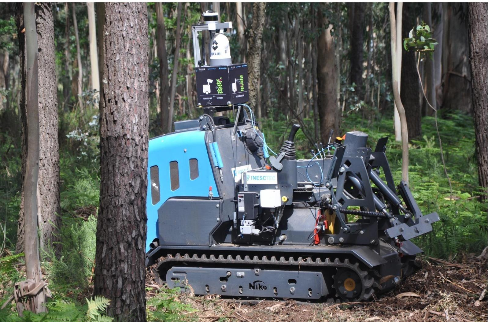
como os das cabeças de plantação da *Bracke* e da *Risutec*, mas de menor escala e incorporados num veículo autónomo.
