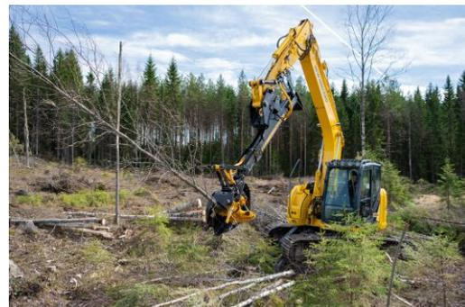
**Figura 8 - Cabeça de desbaste acoplada a grua com extensor. Produzida pela empresa TMK Tree Shear.**
