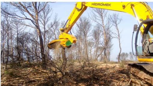
**Figura 10 - Cabeça de trituração para desbaste da empresa espanhola Serrat**
