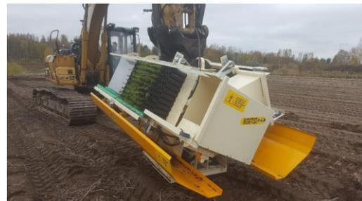
**Figura 25 - Mecanismo plantador automático da empresa Risutec**
