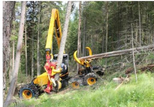
**Figura 17 - Harvester HIGHLANDER capaz de abate, manuseamento e arraste, e processamento. Produzido pela empresa Konrad.**
