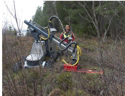
**Figura 5 - Forest beaver. Veículo de pequeno porte remotamente operada, com braço e cabeça de corta-mato. Produzido pela empresa beaver.**
