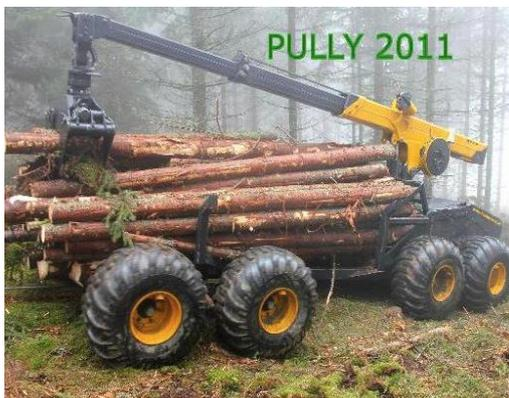
**Figura 16 - Transportador terrestre PULLY com grua e garra florestal. Produzido pela empresa Konrad.**
