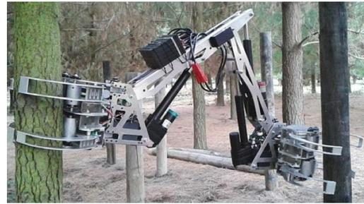
**Figura 11 - Stick Insect. Mecanismo "tree-to-tree" para desbaste. Desenvolvido pelo Instituto de Investigação Scion e pela Universidade de Canterbury.**
