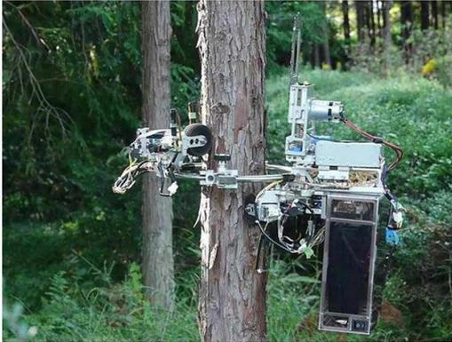
**Figura 7 - Tree-Pruning Robot. Desenvolvido por Yasuhiko Ishigure, Katsuyuki e Haruhisa Kawasaki. Este robô desloca-se ao longo da árvore em movimento vertical ou em espiral e executa a desramação por meio de uma motosserra.**
