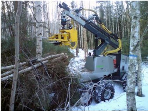
**Figura 9 - Ebeaver. Veículo remotamente operado usando uma cabeça de corte para desbaste (cabeça da Kesla)**
