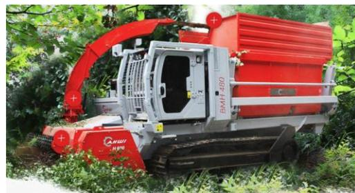
Figura 2 - Biomass harvester da empresa Prinoth. Possui um sistema que permite a trituração e a recolha da biomassa.
