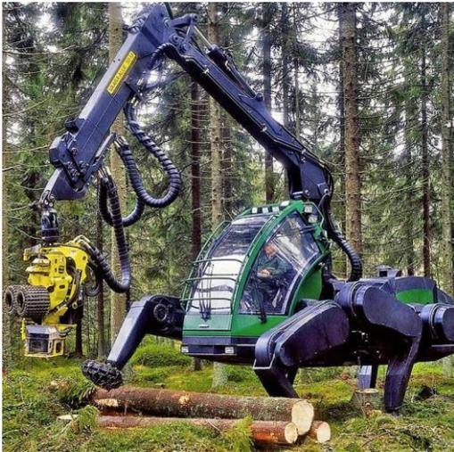
**Figura 13 - Trator com patas (hexapod) da empresa John Deere.**
