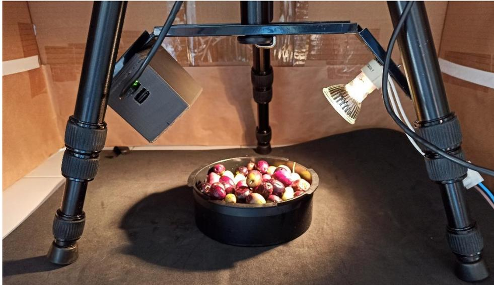
*Figura 4. Imagen del prototipo desarrollado con el sensor multiespectral a la izquierda y la fuente de luz a la derecha*
