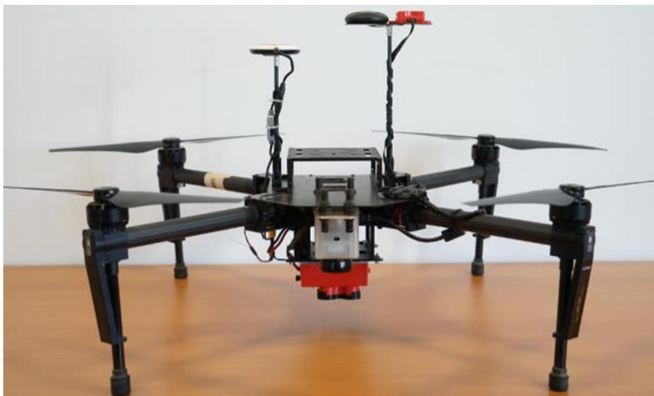
*Figura 3. Micasense Rededge-M instalada en la plataforma aérea (DJI Matrice 100)*
