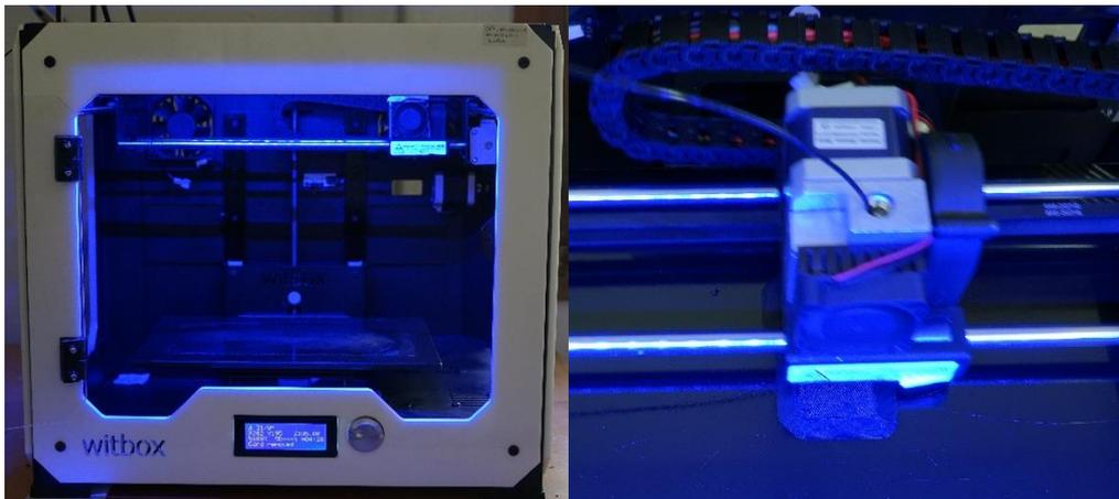
*Figura 7: Impresión 3d del encapsulado del sensor de suelo de bajo coste.*
