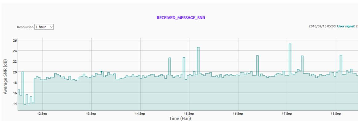
Figura 10: Relación señal-ruido (SNR) en las transmisiones a la red Sigfox desde la localización de prueba.
