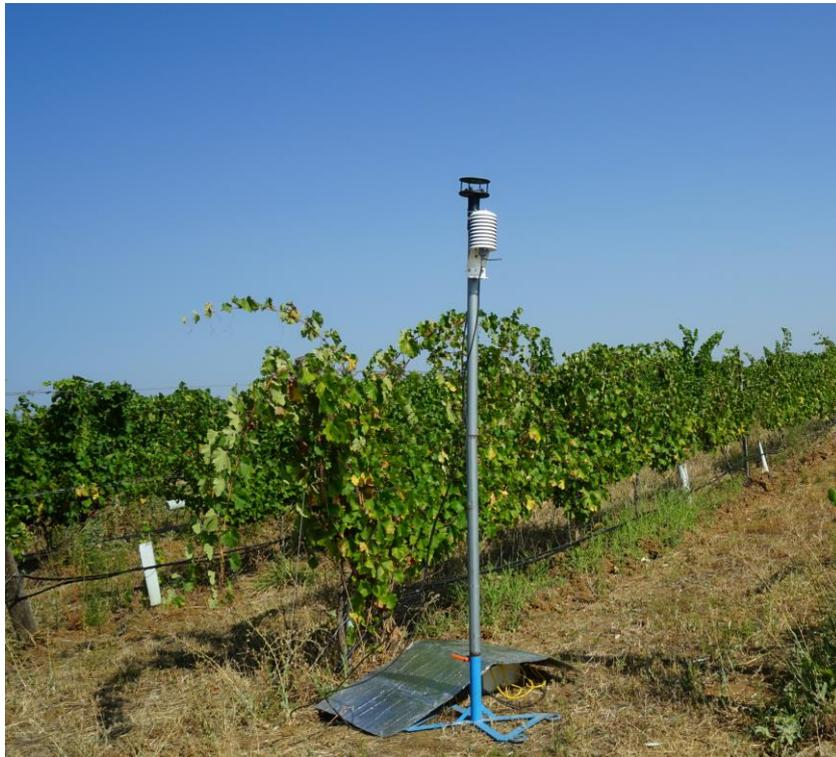
*Figura 12: Estación meteorológica portátil (proporcionada por INIAV) para la calibración de las mediciones aéreas en campo utilizada en los experimentos realizados en 2018.*
