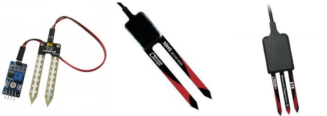
Figura 5: Sensores de suelo. De izquierda a derecha: Sensor de bajo coste, Decagon 10HS y Decagon 5TE.
