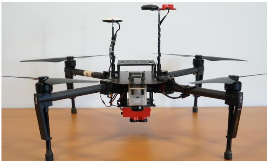
*Figura 7: Micasense Rededge-M instalada junto con el receptor GNSS y el DLS (de color rojo en la parte superior).*
