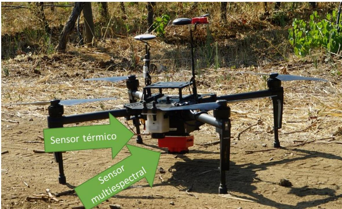
Figura 4: Plataforma aérea (DJI Matrice 100) con sensor térmico y espectral integrados como carga de pago.
