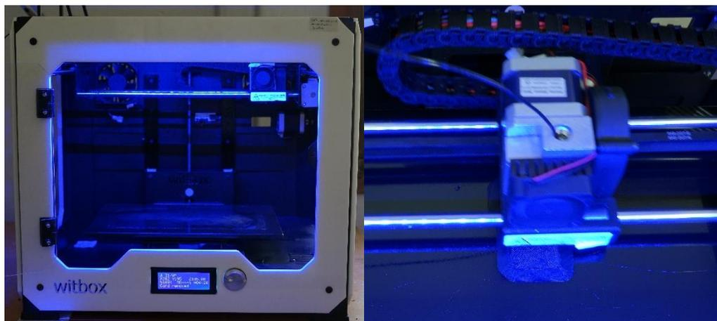
Figura 3: Impresión 3d del soporte del sensor FLIR Vue Pro R.
