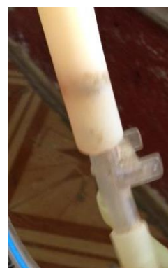
Εικόνα 5.4. Ροζ πλάκες ενδεικτικές της ανάπτυξης μικροβίων (αριστερά) και σκουριά (δεξιά) στο εσωτερικό των ελαστικών σωλήνων του αρμεκτηρίου.
