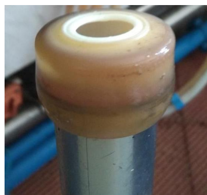
Εικόνα 5.2. Σπασμένο θήλαστρο (αριστερά) και θήλαστρο με βύθιση της επιφάνειας του στομίου του (δεξιά).
